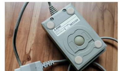
DAS HALLERTAUER DING #3. Das ist ein altes „optomechanisches“ Eingabegerät (Befehlsgeber) für den Computer. Die Rollbewegung der Kugel wurde über zwei Walzen auf gelochte Segment-scheiben übertragen. So konnten Richtung und Geschwindigkeit ermittelt und über Lichtschranken in elektrischen Impulsen übertragen werden. *mehr ...*
